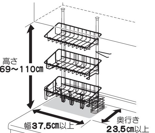
● 支柱本体と高さ調整支柱は上下どちらでも組立てることができます。棚取付範囲が変わりますので、あらかじめ設置場所に支柱を当てて棚取付範囲を確認してから組立ててください。
