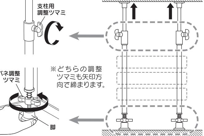
2 脚を押さえながらバネ調整ツマミを回し、バネが縮むところまで移動させてしっかりと突っ張り固定してください。
