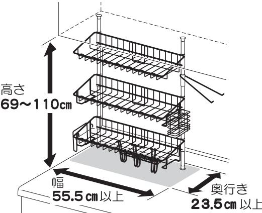
① 支柱本体と高さ調整支柱は上下どちらでも組立てることができます。棚取付範囲が変わりますので、あらかじめ設置場所に支柱を当てて棚取付範囲を確認してから組立ててください。
