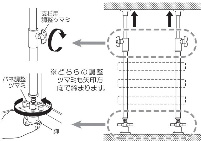
2 脚を押さえながらバネ調整ツマミを回し、バネが縮むところまで移動させてしっかりと突っ張り固定してください。
