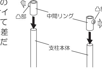
3 支柱本体に高さ調整支柱を最後まで差し込み、支柱用調整ツマミで仮止めしてください。(2本とも)
