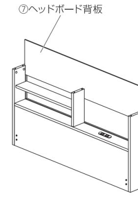
◎連結金具(6か所)をはめ込み、◎連結ボルト(6か所)をねじ込んだ⑧ヘッドボード天板を連結金具で固定してください。
